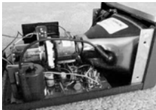
A vezérlő tekercsek elektromágneses mezőt keltenek
